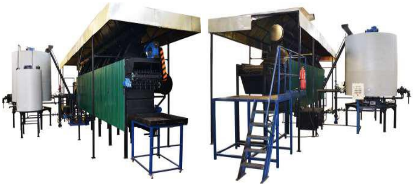
Рисунок 2.4.1 – Технологический комплекс для утилизации отходов битумсодержащих кровельных и изоляционных материалов
